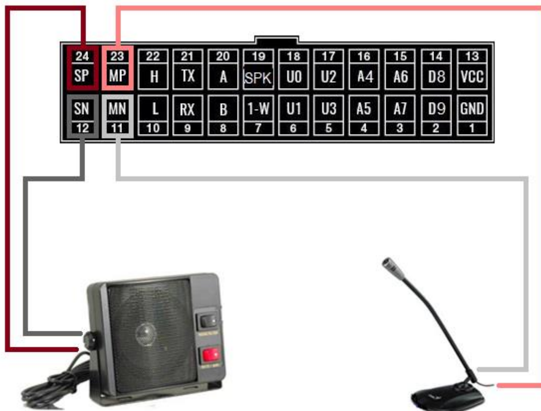
Рисунок 9 – Схема подключения микрофона и динамика
